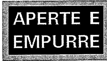
Figura 08 – Sinalização para portas com barramento antipânico
