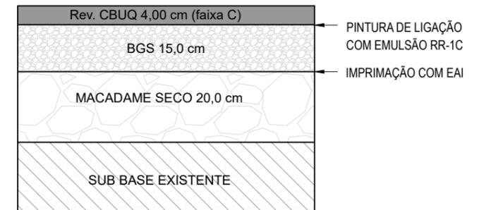
DETALHE COMPOSIÇÃO DO PAVIMENTO SEM ESCALA
