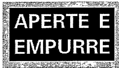
Figura 08 – Sinalização para portas com barramento antipânico
